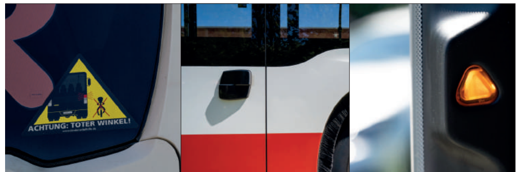
Gegen den toten Winkel: Sicherheitskonzepte bei den neuen Bussen mit Warnhinweisen für den nachfolgenden Verkehr, Seitensensoren und optischen Signalen für den Fahrer.
