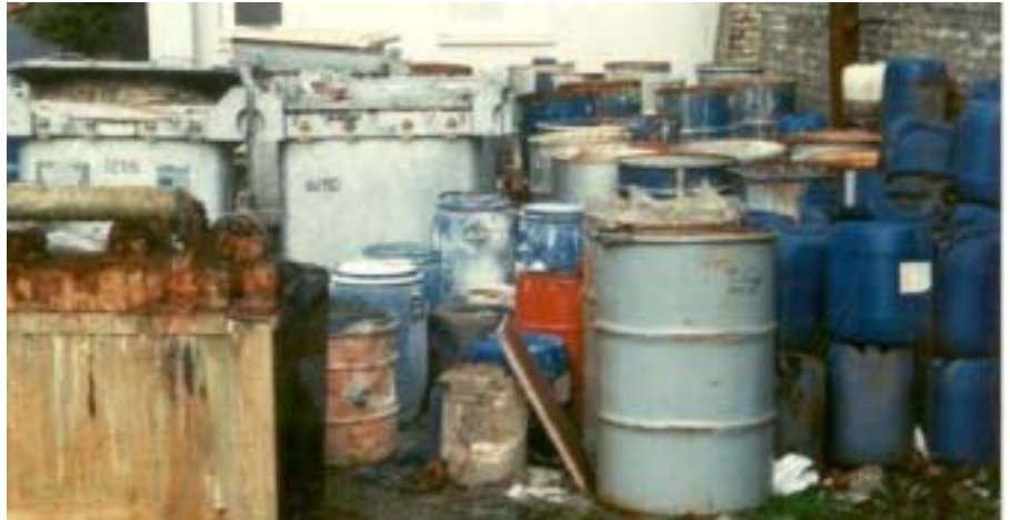
Abb.: Arbeits- und Umweltschutz liegen nah beieinander: Unsachgemäße Lagerung von Gefahrstoffen
