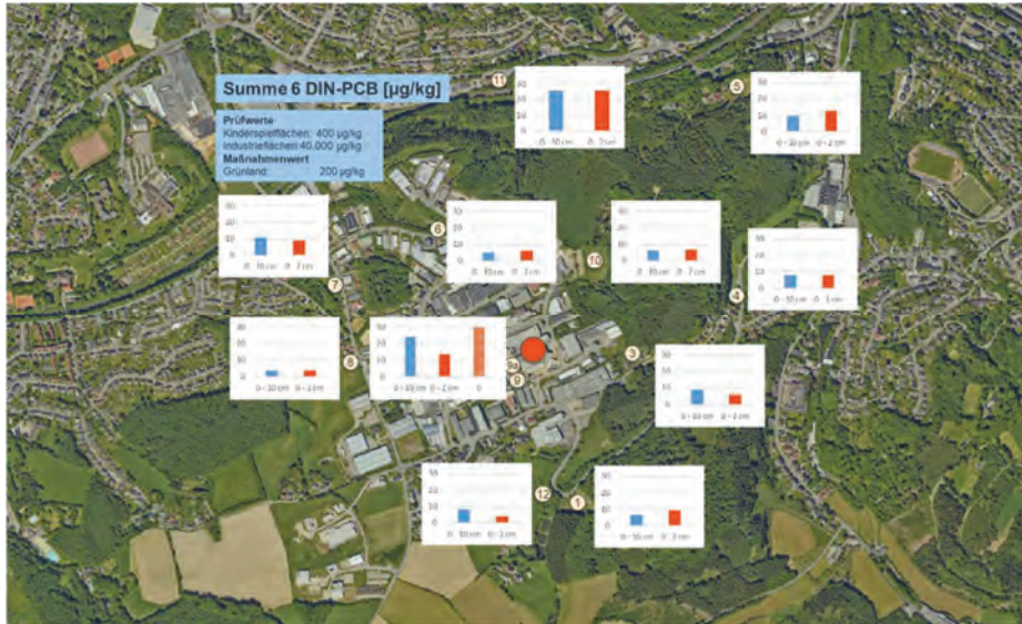
Abbildung 3: PCB 6 -Gehalte (Summe der 6 DIN-PCB) der untersuchten Bodenproben
